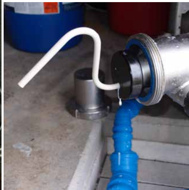
Engangskittet klar til prøveudtagning. Røret er på billedet monteret i en tom tank.
